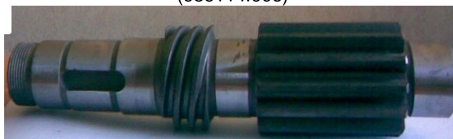
Вал - шестерня 106-39Б (986114.006)
